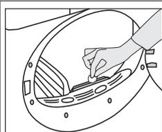
Votre sèche-linge est équipé de capteurs de séchage qui détectent si le linge est sec ou non. Pour nettoyer les capteurs :
