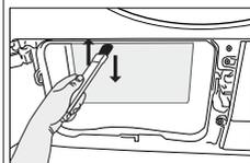
Les peluches collectées sur la surface du condenseur doivent être enlevées avec un chiffon humide ou en frottant la brosse placée sur le couvercle d'acheminement de l'air de haut en bas sur le condenseur.
