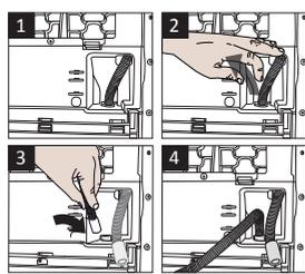
**1-2** Tirez à la main le tuyau derrière le sèche-linge afin de le débrancher de son point de connexion. N'utilisez aucun outil pour retirer ce tuyau..
