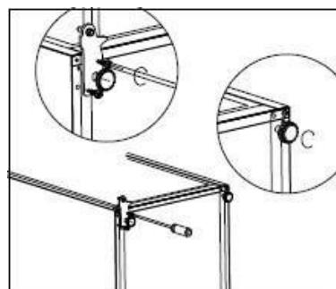
6. Retire las juntas de la puerta del congelador y vuelva a colocarlas después de girarlas
