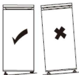
Si l'appareil n'est pas à niveau, les portes ne seront pas correctement alignées et l'étanchéité des compartiments peut ne pas être assurée. Pour mettre l'appareil à niveau latéralement, ajustez les deux pieds réglables à l'avant du produit.
