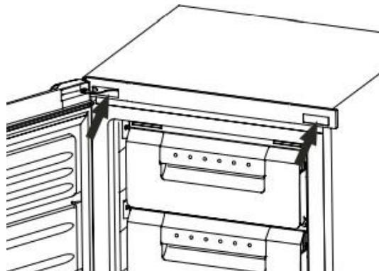
9. Avec la porte fermée, vérifiez que la porte est alignée horizontalement et verticalement et que les joints sont fermés de tous les côtés avant de serrer définitivement la charnière inférieure. Réajustez les pieds de nivellement si nécessaire.
