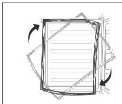
7. Coloque la puerta. Asegúrese de que la puerta está alineada horizontal y verticalmente de manera que las juntas estén cerradas en todos los lados antes de apretar la bisagra superior.
