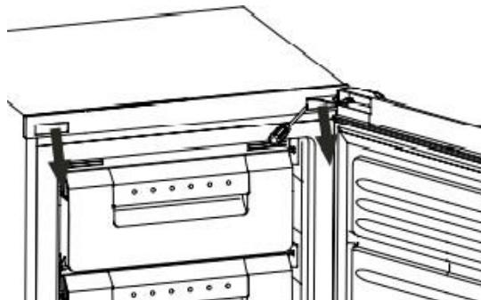
2. Retire los dos tornillos y después la bisagra superior que sujetla la puerta. Levante la puerta y colóquela sobre una superficie acolchada para evitar que se raye.
