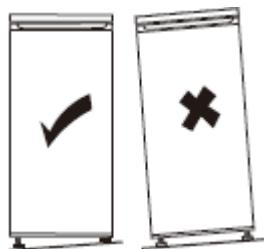
Si el aparato no está correctamente nivelado, las puertas no quedarán bien alineadas y puede que se pierda la hermeticidad de los compartimentos. Para nivelar lateralmente el aparato, ajuste las dos patas delanteras.
