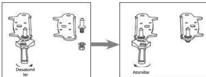
5. Instale la bisagra inferior de izquierda a derecha. Vuelva a colocar los dos pies ajustables.
