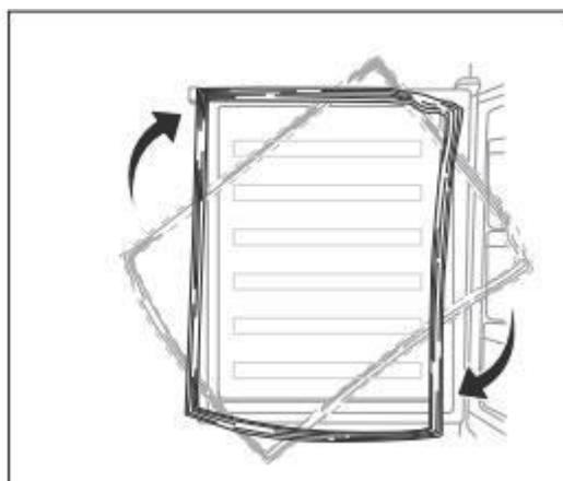
7. Placez la porte. Assurez-vous que la porte est alignée horizontalement et verticalement de manière à ce que les joints soient fermés de tous les côtés avant de resserrer la charnière supérieure.
