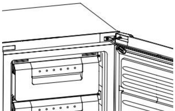
3. Retire los tornillos y la bisagra inferior. A continuación, retire los pies ajustables de ambos lados.
