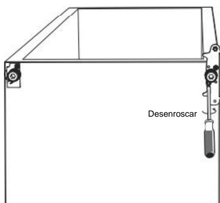
4. Desenrosque y retire el pasador de la bisagra inferior, dele la vuelta al soporte y vuelva a colocarlo.
