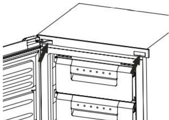
9. Con la puerta cerrada, compruebe que la puerta está alineada horizontal y verticalmente y que las juntas están cerradas en todos los lados antes de apretar definitivamente la bisagra inferior. Reajuste los pies de nivelación si es necesario.
