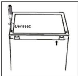
2. Retirez le cache supérieur et la molette de thermostat et placez-les sur le côté.
