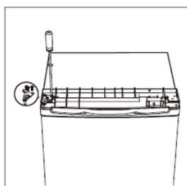
9. Placez le cache supérieur et fixez-le avec les 2 vis à l'arrière.
