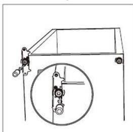
7. Retirez les joints de porte du réfrigérateur et du congélateur, pivotez-les et remettez-les en place.
