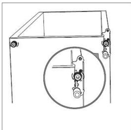
5. Dévissez et retirez la tige de la charnière inférieure, retournez la platine de fixation et remettez-la en place.
