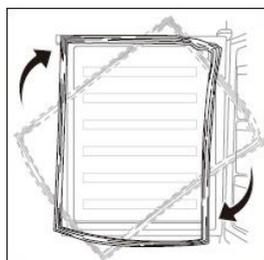
8. Remettez la porte. Assurez-vous que la porte est alignée horizontalement et verticalement de manière à ce que les joints soient fermés de tous les côtés avant de resserrer la charnière supérieure.
