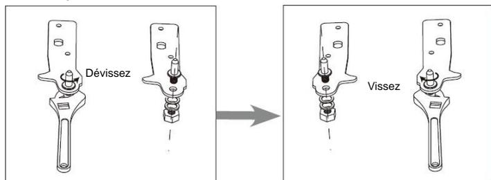
6. Remplacez la platine de fixation équipée de la tige de la charnière inférieure. Remplacez les deux pieds réglables.
