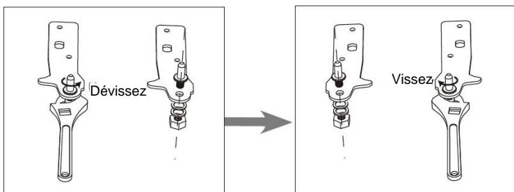
9. Installez la charnière du côté gauche et la base du pied du côté droit. Vissez ensuite les deux pieds de réglage avec leurs pièces d'origine.
