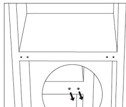
11. Levante el aparato y coloque la puerta en la bisagra inferior. Asegúrese de que el centro de la bisagra inferior esté insertado en el agujero de la puerta. Cambie el embellecedor del agujero de la bisagra de la puerta inferior de la puerta del lado izquierdo al derecho.
