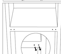
11. Relevez l'appareil et placez la porte sur la charnière du bas. Vérifiez que la tige de la charnière inférieure est insérée dans le trou de la porte. Puis, déplacez le cache-trou de la charnière de la porte inférieure de gauche à droite.
