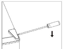
2. Afloje la bisagra superior con un destornillador Philips.
