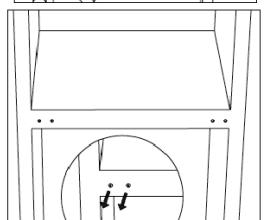
7. Recueste la parte posterior del aparato sobre una superficie suave. Y suelte la bisagra inferior y la pata.
