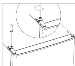
14. Coloque el embellecedor de la bisagra y del agujero en la parte superior de la unidad.
