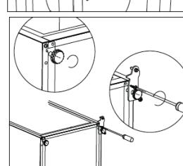
8. Dévissez et retirez la tige de la charnière inférieure, retournez la platine de fixation et remettez-la en place.
