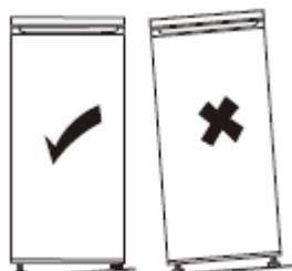
Si el aparato no está correctamente nivelado, las puertas no quedarán bien alineadas y puede que se pierda la hermeticidad de los compartimentos.
