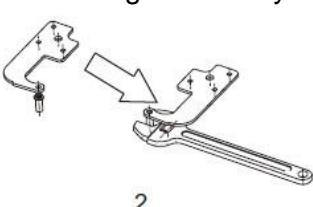
6. Instale la bisagra inferior bajo el frigorífico como se muestra a continuación, atornillando las patas de ajuste, asegúrese de que está perfectamente horizontal.
