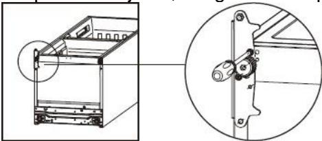
7. Instale la puerta inferior, ajuste y fije la bisagra central en el mueble.
