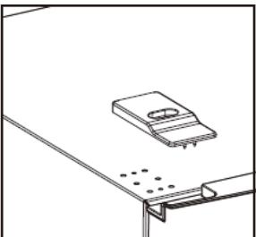
3. Retire la cubierta superior izquierda. Quite la puerta superior, saque el tornillo de la bisagra central con un destornillador cruzado y retire la puerta inferior.
