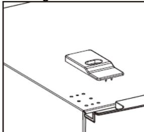
3. Retirez la porte supérieure, retirez la vis de la charnière intermédiaire à l'aide d'un tournevis cruciforme, puis retirez la porte inférieure.
