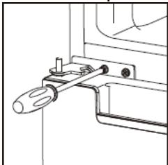
8. Placez la porte supérieure. Assurez-vous que la porte est alignée horizontalement et verticalement de manière à ce que les joints soient fermés de tous les côtés avant de resserrer la charnière supérieure. Puis maintenez la charnière supérieure en place et vissez-la au sommet l'appareil. Enfin, fixez le cache charnière (situé dans le sachet d'accessoire) à l'aide la vis.
