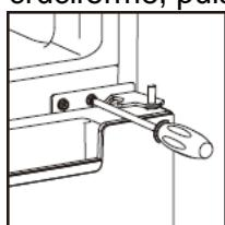
4. En allongeant le réfrigérateur, retirez les pieds de réglage comme présenté ci-dessous, puis retirez la charnière inférieure à l'aide d'un tournevis cruciforme
