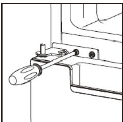
8. Vuelva a colocar la puerta superior. Compruebe que la puerta queda alineada horizontal y verticalmente de manera que la junta esté bien cerrada antes de apretar la bisagra superior: A continuación, inserte la bisagra superior y atorníllela a la parte superior de la unidad y fije el embellecedor de la bisagra (en la bolsa de accesorios) atornillándola.
