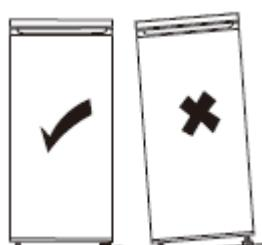
Si l'appareil n'est pas à niveau, les portes ne seront pas correctement alignées et l'étanchéité des compartiments peut ne pas être assurée.
