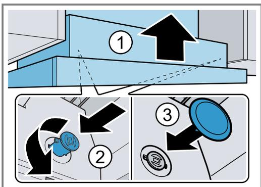
2. Largeur de l'appareil 90 cm : tirez le tiroir-filtre complètement vers l'avant. Vissez également l'appareil sur les meubles supérieurs latéraux par le bas avec 2 vis chacune à gauche et à droite.
