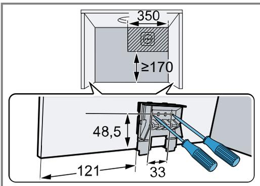
8. Épaisseur de paroi de 19 mm : rabattez la barre de distance sur les deux éléments de fixation.
