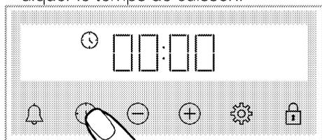
**i** Une fois la fonction et la température réglées, vous pouvez régler le temps de cuisson pour 30 minutes en appuyant directement sur la touche ⊕ pour un réglage rapide du temps de cuisson et modifier le temps à l'aide des touches ⊕/⊖.
