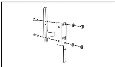
4. Alignez la base du crochet de la bride de fixation sur la base de la coupe de la plaque de fixation au mur.
