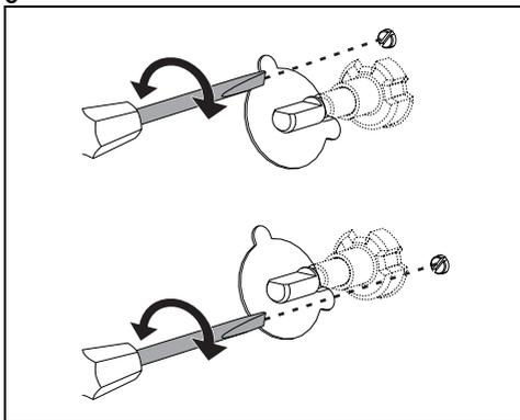
Allumez le brûleur et mettez-le en position minimum. Extrayez la poignée du robinet de gaz et agissez sur la vis de réglage située à côté de la tige du robinet (selon les modèles), jusqu'à obtenir une flamme minimale régulière.
