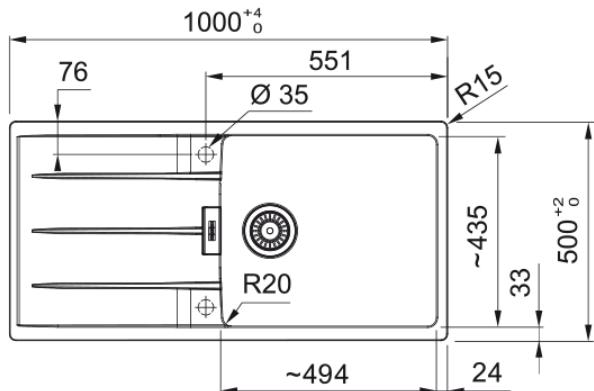
Evier CENTRO, CNG 611-XL Gris Ardoise, à encastrer 1000x500 mm. Sa matière Fragranite résiste aux rayures, aux chocs et aux taches. Vidage automatique, Trop plein design inox avec sa bonde et son bouton rotatif. Tous ces accessoires qui permettent une installation en toute tranquillité.
