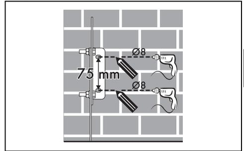
8. Après avoir réalisé les trous dans le mur, utilisez des chevilles avec des vis pour fixer la bride sur le mur.
