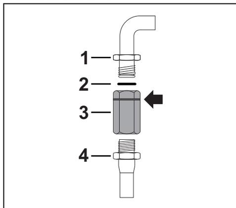
Appliquez du matériau isolant sur le filet du tuyau de gaz 4 avant d'y visser l'adaptateur 3. Vissez le bloc sur le raccord mobile 1 de l'appareil en interposant toujours le joint 2 fourni.
