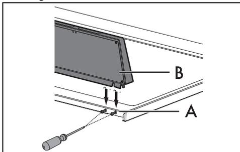
Le dossieret doit toujours être positionné et correctement fixé sur l'appareil.
