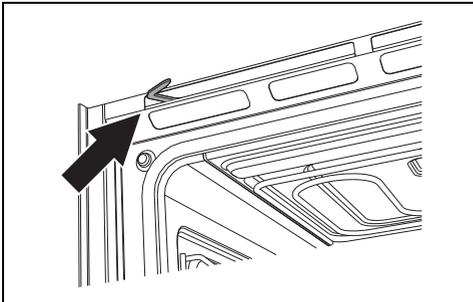
Durant les opérations normales de nettoyage, il peut arriver d'actionner accidentellement le levier de verrouillage de la porte.
