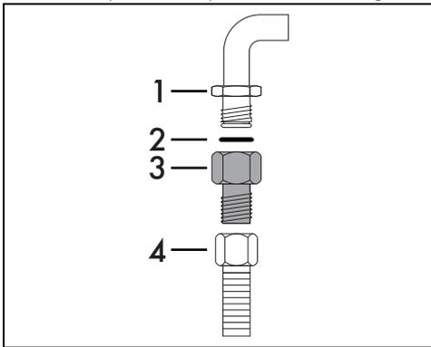
Vissez soigneusement le raccord 3 au raccord du gaz 1 (fileté 1/2" ISO 228-1) de l'appareil en interposant toujours le joint 2 fourni. Appliquez du matériau isolant sur le filet du raccord 3, puis vissez le tuyau flexible en acier 4 au raccord 3.
