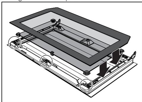
7. Pour repositionner la vitre interne, introduisez la partie antérieure dans les clips dans la porte et encastrer les 2 pivots arrière dans leurs logements avec une légère pression.
