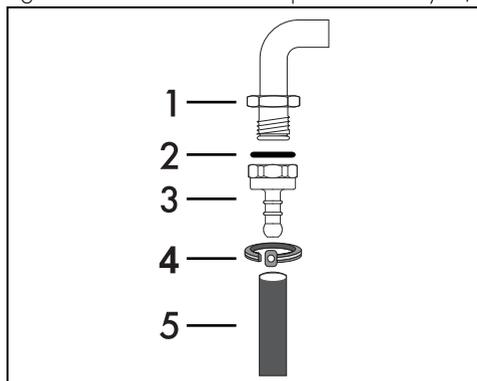
Vissez minutieusement l'embout 3 sur le raccord du gaz 1 (filet 1/2" ISO 228-1) de l'appareil en interposant le joint 2. Après avoir vissé l'embout, introduisez le tuyau du gaz 5 sur celui-ci et fixez-le avec le collier 4 conforme à la norme en vigueur.
