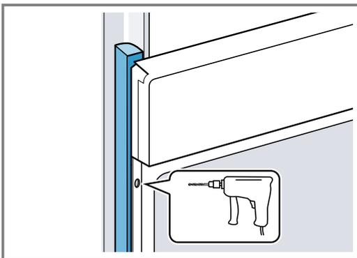
3. Fixer l'appareil avec une vis adéquate.
