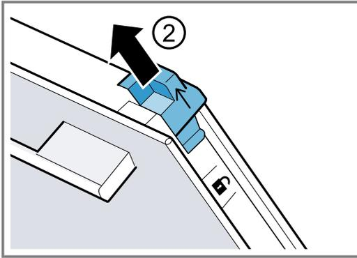
6. Retirez la vitre intérieure en diagonale vers le haut et déposez-la avec précaution sur une surface plane.
