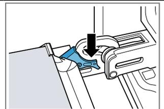
La porte de l'appareil est sécurisée et ne peut pas être décrochée.
