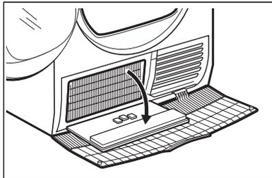
5. Si nécessaire, retirez les peluches sur le condenseur et dans son compartiment. Vous pouvez utiliser un aspirateur avec
