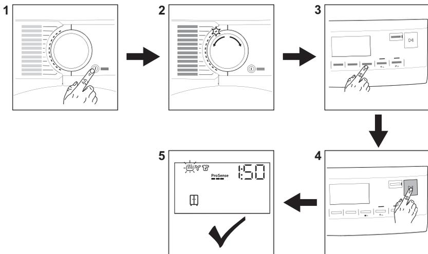
1. Appuyez sur la touche **Marche/Arrêt** pour mettre en fonctionnement l'appareil.
