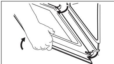
4. Mettez la porte sur un chiffon doux sur une surface stable et relâchez le système de verrouillage pour retirer le panneau de verre interne.
