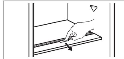
Pour retirer le dispositif de contrôle de l'humidité, ouvrez le bac sous l'étagère en verre et retirez le couvercle.
