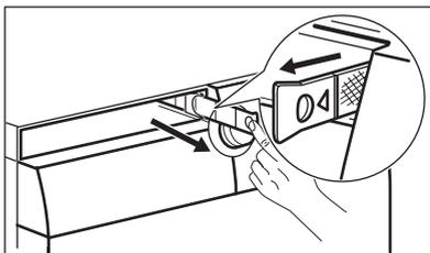
7. Nettoyez le filtre à air secondaire à la main et, si nécessaire, avec un aspirateur. Jetez la peluche dans une poubelle.
