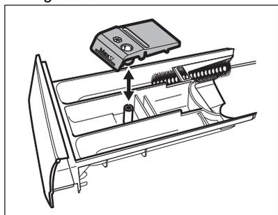
3. Rincez le distributeur de produit de lavage sous de l'eau courante chaude pour éliminer toute trace de lessive accumulée. Après le nettoyage, remettez la partie supérieure en place.
