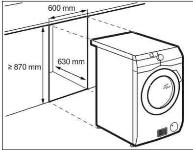
L'appareil peut être installé de façon autonome ou sous un plan de travail de cuisine si un espace correct est disponible (voir schéma).
