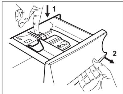
2. Retirez la partie supérieure du compartiment à additifs pour faciliter le nettoyage. Assurez-vous d'éliminer tous les résidus de lessive dans les parties supérieure et inférieure du logement. Utilisez une petite brosse pour nettoyer le logement.
