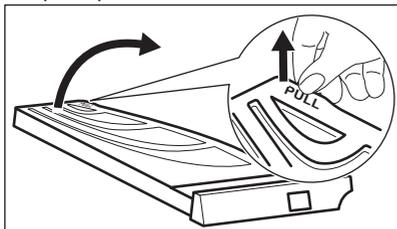
4. Nettoyez le filtre à air principal à la main et, si nécessaire, avec un aspirateur. Jetez la peluche dans une poubelle.
