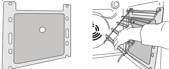
Pour profiter au maximum des propriétés auto-nettoyantes des panneaux catalytiques, nous vous conseillons de chauffer le four à 200 °C pour environ une heure en utilisant la fonction « Convection forcée ». Le four doit être vide durant cette opération. Laissez ensuite le four refroidir avant d'enlever les résidus d'aliments qui restent avec une éponge non abrasive.
