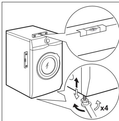
L'appareil doit être stable et d'aplomb.
