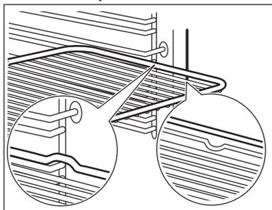
Insérez la grille entre les barres de guidage des supports de grille et assurez-vous que les pieds sont orientés vers le bas.
