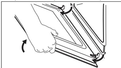
4. Mettez la porte sur un chiffon doux sur une surface stable et relâchez le système de verrouillage pour retirer les panneaux de verre.
