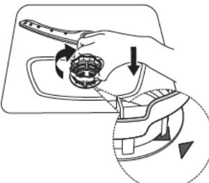
4 Remontez les filtres en suivant les étapes de démontage dans l'ordre inverse, replacez le dispositif de filtration et tournez-le dans le sens horaire jusqu'à la flèche de fermeture.
