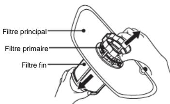
2 Vous pouvez retirer le filtre fin situé en bas du dispositif de filtration. Démontez le filtre primaire du filtre principal en appuyant délicatement sur les languettes situées en haut avant de retirer le filtre.
