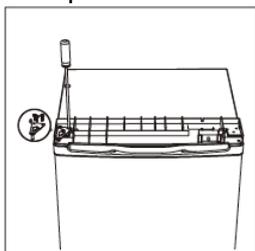
12. Placez le cache supérieur et fixez-le avec les 2 vis à l'arrière.
