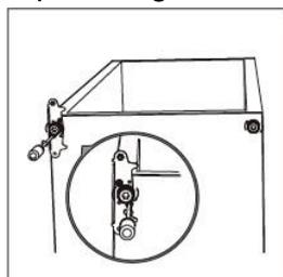
11. Remettez la porte. Assurez-vous que la porte est alignée horizontalement et verticalement de manière à ce que les joints soient fermés de tous les côtés avant de resserrer la charnière supérieure.
