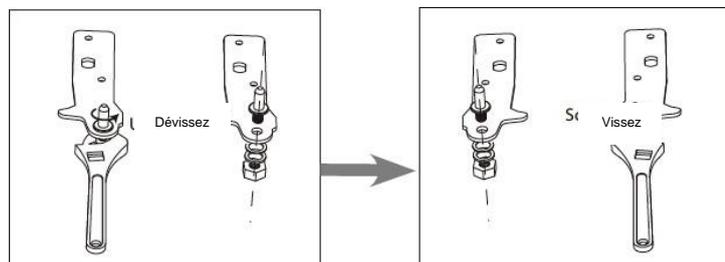
10. Replacez la platine de fixation équipée de la tige de la charnière inférieure. Replacez les deux pieds réglables.
