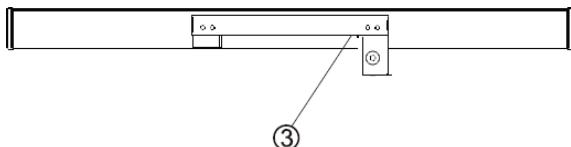
3. Vissez le crochet de verrouillage ④ sur l'armoire du congélateur avec 2 autres vis ①.
