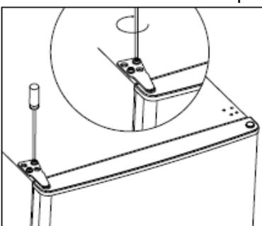
12. Reclipser le cache charnière et remettez le cache-trou sur le haut de l'appareil.
