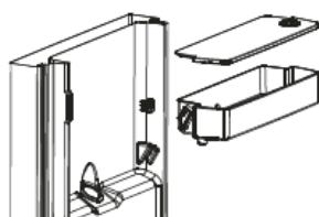
3. Tras la limpieza, vuelva a colocar el depósito de agua, la tapa y el compartimento de puerta como se indica a continuación.
