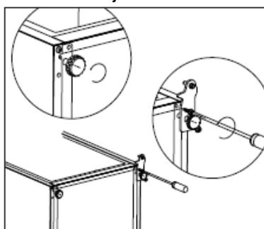
7. Suelte la placa de fijación con el pasador de la bisagra inferior y vuelva a colocarla.
