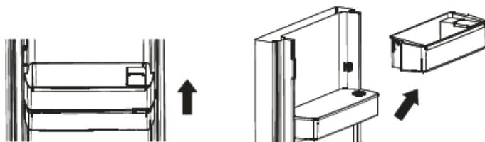
2. Retirez le réservoir d'eau. Retirez le cache supérieur afin de nettoyer le réservoir et son cache.
