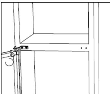
11. Placez la porte supérieure. Assurez-vous que la porte est alignée horizontalement et verticalement de manière à ce que les joints soient fermés de tous les côtés avant de resserrer la charnière supérieure. Insérez ensuite la charnière et vissez-la en haut de l'appareil.
