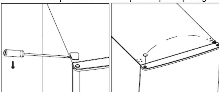
4. Suelte la bisagra intermedia. A continuación, levante la puerta inferior y colóquela sobre una superficie plana y protegida para evitar que se raye.
