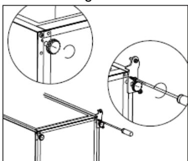
7. Dévissez la platine de fixation équipée de la tige de la charnière inférieure et replacez-la.
