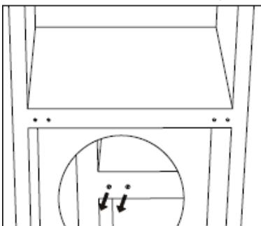
6. Tumbe el aparato boca arriba y afloje la bisagra inferior. A continuación, retire los pies ajustables de ambos lados.
