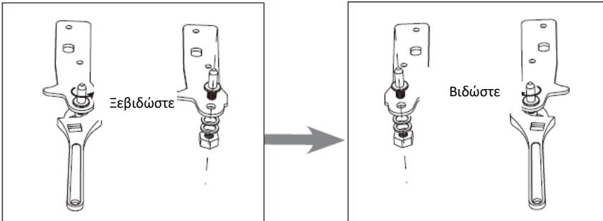
8. Τοποθετήστε τον κάτω μεντεσέ από αριστερά προς τα δεξιά. Αντικαταστήστε τα δύο ρυθμιζόμενα πόδια.
