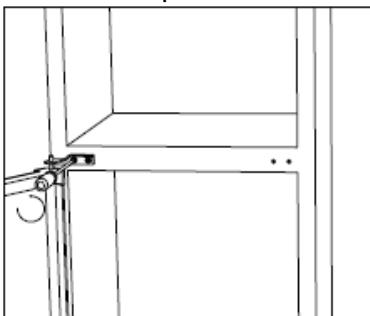
11. Coloque la puerta superior. Asegúrese de que la puerta está alineada horizontal y verticalmente de manera que las juntas estén cerradas en todos los lados antes de apretar la bisagra superior. A continuación, introduzca la bisagra y atorníllela en la parte superior del aparato.
