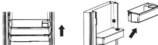
2. Retire el dispensador de agua. Separe la tapa para lavar y limpiar el depósito y la tapa.
