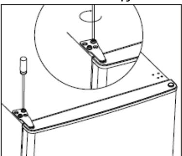
12. Κουμπώστε ξανά το κάλυμμα μεντεσέδων και επανατοποθετήστε το κάλυμμα της οπής στο επάνω μέρος της συσκευής.
