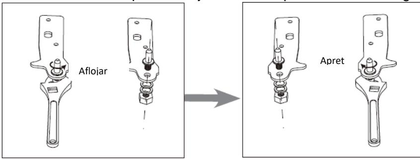
8. Instale la bisagra inferior de izquierda a derecha. Vuelva a colocar los dos pies ajustables.
