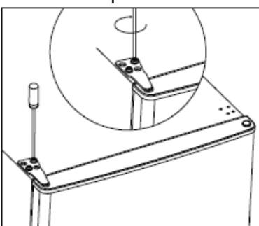
12. Vuelva a colocar la tapa de la bisagra y el tapón del agujero en la parte superior del aparato.
