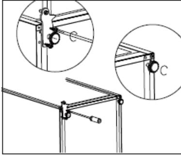
9. Levante el aparato y vuelva a colocar la puerta en la bisagra inferior. Compruebe que la bisagra está bien colocada en la puerta. A continuación, mueva los tapones de los agujeros de la puerta inferior de izquierda a derecha.
