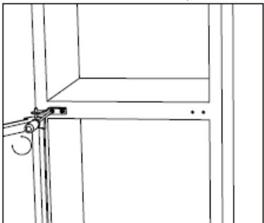
11. Τοποθετήστε την επάνω πόρτα. Βεβαιωθείτε ότι η πόρτα είναι ευθυγραμμισμένη οριζόντια και κάθετα, έτσι ώστε οι φλάντζες να είναι κλειστές από όλες τις πλευρές πριν βιδώσετε ξανά τον επάνω μεντεσέ. Στη συνέχεια, τοποθετήστε τον μεντεσέ και βιδώστε τον στο επάνω μέρος της συσκευής.
