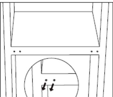
6. Τοποθετήστε τη συσκευή στο πίσω μέρος και, στη συνέχεια, ξεβιδώστε τον κάτω μεντεσέ. Στη συνέχεια, αφαιρέστε τα ρυθμιζόμενα πόδια και από τις δύο πλευρές.
