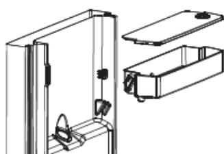
3. Une fois le nettoyage terminé, replacez le réservoir d'eau, le cache et le balconnet comme suit :
