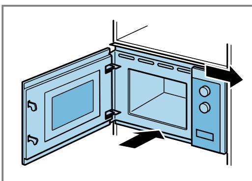
**3. Das Gerät so lange festschrauben, bis das Gerät mittig ausgerichtet ist.**
