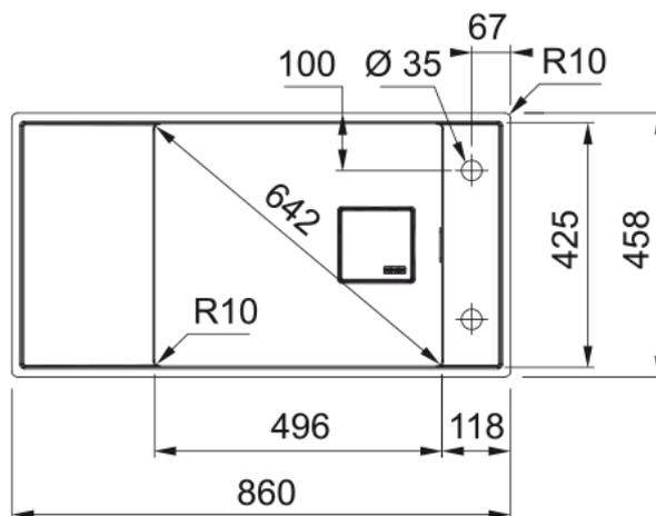
Cuve FRESNO, FNG 111-86 Gris Ardoise, sous-plan 860x458 mm. Sa matière Fraganite résiste aux rayures, aux chocs et aux taches. Vidage automatique, cache-bonde carré inox, Trop-plein discret, rollmat inox. Tous ces accessoires qui permettent une installation en toute tranquillité.
