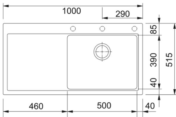
Evier MYTHOS, MTG 611 Gris Ardoise, à encastrer 1000x515 mm. Egouttoir à gauche. Sa matière Fraganite résiste aux rayures, aux chocs et aux taches. Vidage automatique, Trop-plein discret, Bouton rotatif inox. Tous ces accessoires qui permettent une installation en toute tranquillité.
