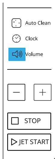
Diese Funktion ermöglicht die Aktivierung/Deaktivierung aller vom Gerät ausgegebenen Geräusche, unter anderem bei Tastenbetätigungen, Warnungen, Alarmen und akustischer Rückmeldung bei Programmende.
