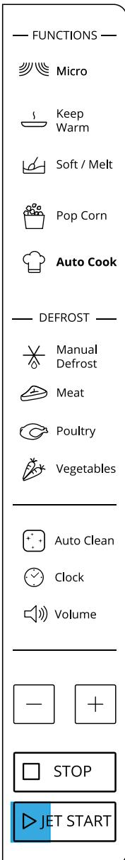
Questa funzione consente di avviare rapidamente il forno. Premendo una volta JET START, il forno inizia automaticamente a funzionare alla massima potenza. Durante la cottura, premere JET START per aggiungere tempo. Il tempo di cottura più lungo è 90 minuti.
