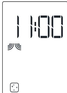
Dies ist ein automatischer Reinigungsvorgang, der Ihnen bei der Reinigung des Garraums der Mikrowelle behilflich ist und unangenehme Gerüche entfernt.
