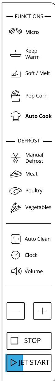
Diese Funktion ermöglicht Ihnen die schnelle Inbetriebnahme des Ofens. Drücken Sie einmal JET START (JETSTART) und der Ofen beginnt automatisch bei voller Leistung zu arbeiten. Drücken Sie während des Garens zum Erhöhen der Garzeit JET START (JETSTART). Die maximale Garzeit beträgt 90 Minuten.
