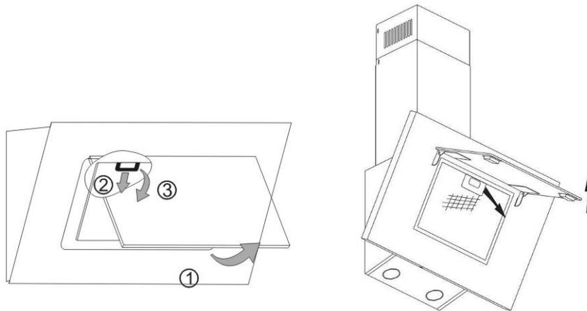
Le filtre doit être positionné à la sortie de la hotte et fermement verrouillé afin de garantir l'étanchéité de l'ensemble
