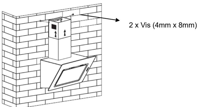
Ouvrez le couvercle d'accès aux filtres et à l'aide de 2 vis (4 mm x 30 mm), vissez dans les deux trous à l'intérieur. Cette action permet de fixer et sécuriser la hotte
