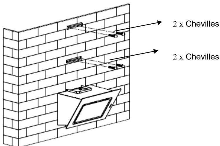
Mettez la cheminée sur le corps de la hotte aspirante ; fixez la « plaque I » sur les deux trous inférieurs du mur à l'aide de 2 vis (4 mm x 40 mm). Serrez les deux côtés de la cheminée sur la hotte avec 2 vis (4 mm x 8 mm).
