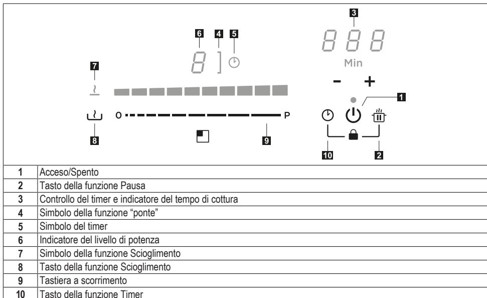
Le zone di cottura possono essere attivate premendo il digit di riferimento . Il digit si illumina più intensamente per confermare l'operazione.
