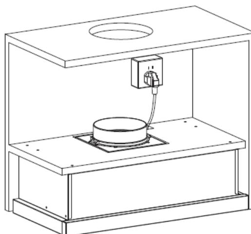
S'il y a un écart entre le mur et la hotte, vous devez installer le support en forme de L au bas de la hotte à l'aide de deux vis (3 x 12 mm).
