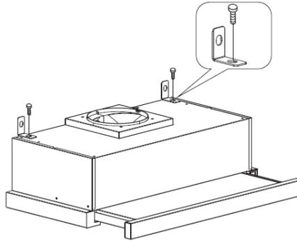
3. La hotte est fixée au mur au moyen de 4 vis (4 x 30 mm) avec chevilles appropriées. Installer la hotte sur le mur à l'arrière de la hotte à l'aide de 2 vis (4mm x 30mm) avec chevilles appropriées installées. Fixez ensuite la hotte au mur à l'aide de 2 vis (4 x 30 mm) à travers le petit support en forme de L.
