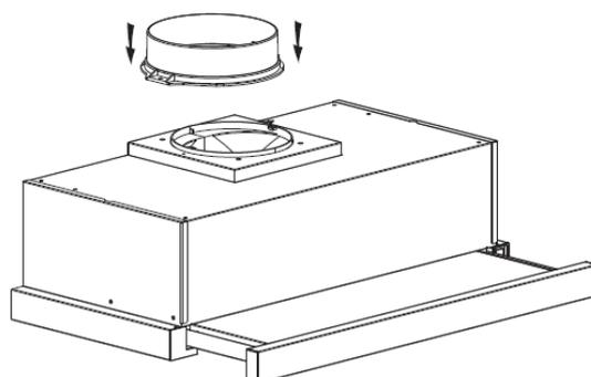
2- Installez la hotte dans le meuble à l'aide des 6 vis (4x35mm) et des rondelles plates.
