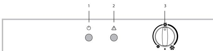
1. Svjetlo indikatora napajanja
