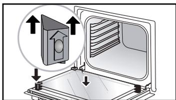
Coloque o último vidro nos batentes em metal, e depois insira-o com a face a indicar «PYROLYTIC» virada para si e visível.
