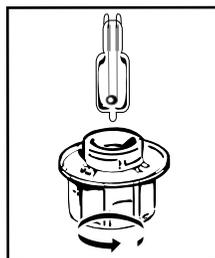
Sie können die defekte Lampe selbst austauschen. Drehen Sie die Glasabdeckung heraus und entfernen Sie dann die Lampe (das Tragen eines Gummihandschuhs erleichtert die Demontage). Bauen Sie die neue Lampe ein und setzen Sie die Glasabdeckung wieder ein.
