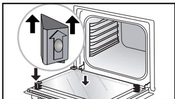
Sätt den sista glasrutan i metallbussningarna och clippsa fast den med sidan märkt **PYROLYTIC** vänd mot dig och läslig.
