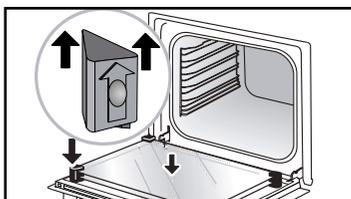
Aseta lasi metallitukia vasten ja kiinnitä se klipseihin siten, että "PYROLYTIC"-merkinnällä varustettu pinta tulee itseäsi vasten ja teksti on luettavissa.
