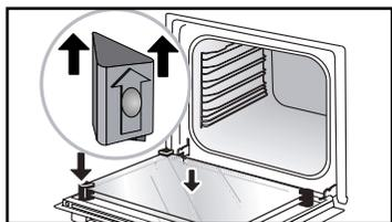
Steek het laatste glas in de metalen blokjes, klik dit daarna vast, met de zijde met "PYROLYTIC" zichtbaar en naar u gericht.
