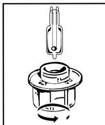
U kunt de lamp zelf vervangen wanneer deze niet meer werkt. Schroef het venster en daarna de lamp los (gebruik een rubber handschoen, die de demontage zal vergemakkelijken). Plaats de nieuwe lamp en zet het venster terug.
