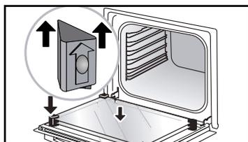
Włożyć ostatnią szymb do metalowych ograniczników, a następnie zamocować na klips, stroną z napisem „PIROLIZA” ustawioną w kierunku użytkownika i czytelną.
