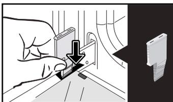
Verwijder het eerste vastgeklikte glas: Druk met de andere wig (of een schroevendraaier) in de inkepingen **A** om het glas los te klikken.
