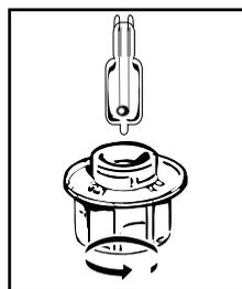
Вы можете сами заменить лампочку, т.к. она уже не работает. Для откручивания светильника и лампы используйте резиновую перчатку, которая облегчит процесс демонтажа. Вставьте новую лампочку и поставьте на место светильник. Данное изделие содержит источник света класса энергоэффективности G.
