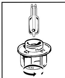
Vous pouvez remplacer vous-même la lampe lorsqu'elle ne fonctionne plus. Dévissez le hublot puis sortez la lampe (utilisez un gant de caoutchouc qui facilitera le démontage). Insérez la nouvelle lampe et remplacez le hublot. Ce produit contient une source lumineuse de classe d'efficacité énergétique G.
