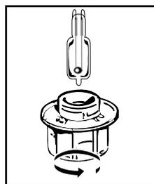
Kiedy lampka nie działa, może zostać wymieniona przez użytkownika. Odkręcić szybę i wyjąć lampkę (należy używać gumowych rękawic - ułatwi to przeprowadzenie demontażu). Włożyć nową lampkę i założyć szybę. Ten produkt zawiera źródło światła o klasie efektywności energetycznej G.
