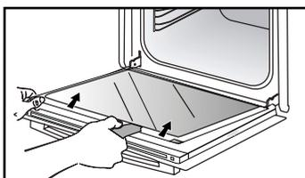
Lågen består af to supplerende glasruder med et sort gummi mellemstykke i hvert hjørne.
