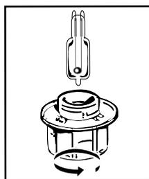
Voit vaihtaa toimimattoman lampun itse. Kierrä suojalasi irti ja irrota lamppu (käytä kumikäsineitä helpottamaan lampun suojalasin irrottamista). Aseta uusi lamppu paikalleen ja suojalasi paikalleen.
