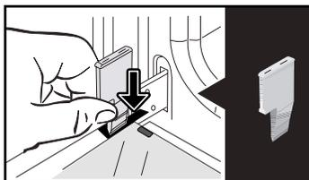
Αφαιρέστε το πρώτο στερεωμένο τζάμι: Χρησιμοποιώντας το άλλο στοπ (ή ένα κατασβίδι), ασκήστε πίεση στις υποδοχές **A**, ώστε να απασφαλίσετε το τζάμι.
