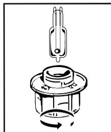
È possibile sostituire autonomamente la lampada quando smette di funzionare. Svitare il coperchio, poi estrarre la lampada (utilizzare un guanto di gomma che faciliterà lo smontaggio). Inserire la nuova lampada e sostituire il coperchio. Questo prodotto contiene una sorgente luminosa di classe di efficienza energetica G.
