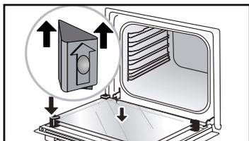
Encaje el último cristal en los topes metálicos y después engánchelo, con la cara que indica «PIROLÍTICO» orientada hacia usted y legible.
