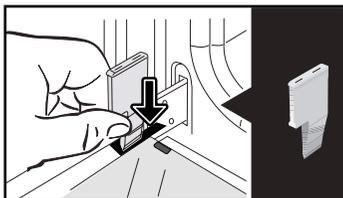
Rimuovere il primo vetro fissato mediante clip:
