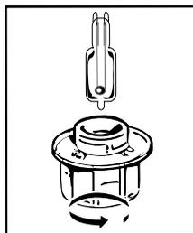
Du kan själv byta lampa när den inte längre fungerar. Använd en gummihandske när du ska skruva loss lampglas och lampa så går det lättare. Sätt i den nya lampan och sätt tillbaka lampglaset.
