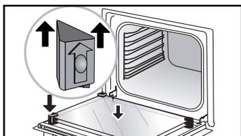
Inserire l'ultimo vetro negli arresti metallici, poi fissarlo con le clip, con il lato che indica "PYROLYTIC" verso di sé e leggibile.
