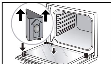
Vložte zadné sklo do kovových držiakov, potom ho zacvaknite tak, aby bol na čele nápis „PYROLYTIC“ otočený smerom k vám a aby bol čitateľný.
