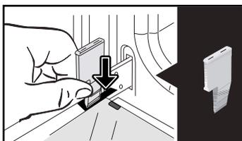
Ta bort den fastclipsade glastrutan: Använd den andra kilen (eller en skruvmejsel) för att trycka i infattningarna **A** och clipsa loss glastrutan.
