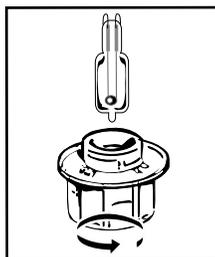
Pode substituir a lâmpada sem ajuda quando deixar de funcionar. Para desmontar o difusor luminoso e a lâmpada, utilize uma luva de borracha para facilitar a desmontagem. Insira a lâmpada nova e substitua o difusor. Este produto contém uma fonte de luz de classe de eficiência energética G.
