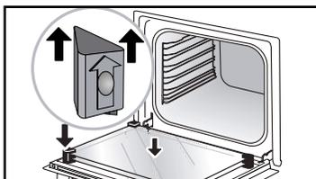
Sett den siste glassruten i metallstopperne, klips den fast med påskriften «PYROLYTIC» vendt mot deg slik at du kan lese det.
