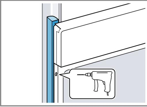
4. Fixez l'appareil avec une vis adéquate.
