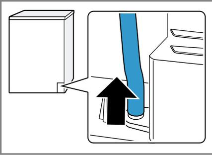
Le tuyau d'eau de condensation est raccordé au manchon en usine.
