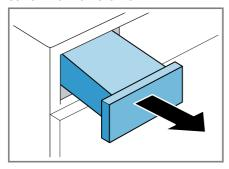
2. Vider le réservoir d'eau de condensation.
