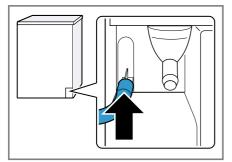
Poussez le tuyau d'évacuation d'eau sur le manchon jusqu'en butée.
