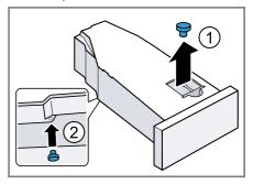
2. Nettoyer le filtre du réservoir d'eau de condensation.
