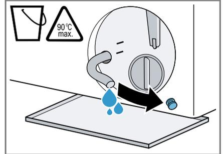
8. Appuyez sur le bouchon de fermeture.
