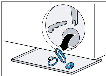
Le couvercle de la pompe se compose de deux composants qui sont démontables pour le nettoyage.
