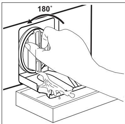
3. Tournez le filtre à 180 degrés vers la gauche pour l'ouvrir, sans le retirer. Laissez l'eau s'écouler.
