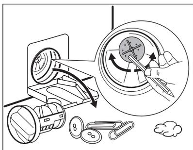
7. Si nécessaire, retirez les peluches et objets du logement du filtre.
