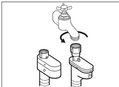
5. Raccordez le tuyau d'arrivée d'eau à un robinet d'eau froide fileté (3/4 pouce).
