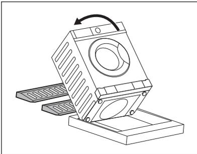
1. Placez deux éléments d'emballage en polystyrène sur le sol sous l'appareil.
