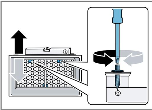
5. Fixez l'appareil par le haut à l'aide de 2 écrous.
