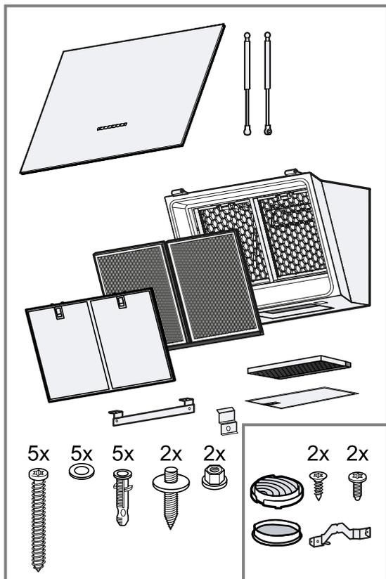
**Conseil :** L'équerre de fixation pour le cache de la cheminée ainsi que les petites vis argentées et noires sont comprises dans la livraison, mais ne sont pas nécessaires pour les appareils à air pulsé.
