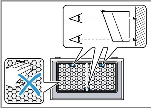
4. Pour aligner l'appareil, ajustez si nécessaire la hauteur de l'appareil par le haut à l'aide d'un tournevis.
