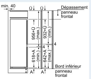
Les dimensions de porte de meuble indiquées sont valables pour un joint de porte de 4 mm. Mesures en mm Mesures en mm Recommandation de dimension d'espace libre pour charnière plate
