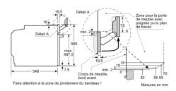
Si l'appareil est installé sous une table de cuisson, les épaisseurs de plaque de travail suivantes (le cas échéant y compris la sous-structure) doivent être respectées.
