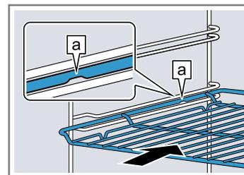
Tôle Introduisez la plaque en orientant la partie biseautée
