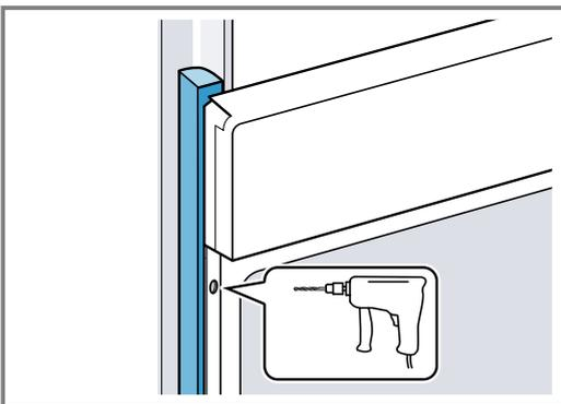
3. Fixer l'appareil avec une vis adéquate.
