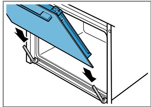
2. Poussez la porte de l'appareil jusqu'en butée à l'aide des deux mains.
