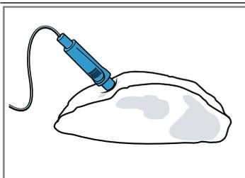
**Remarque :** Si vous souhaitez retourner l'aliment, insérez la sonde de cuisson sur le côté de l'aliment afin de ne pas avoir à la retirer pour le retourner.
