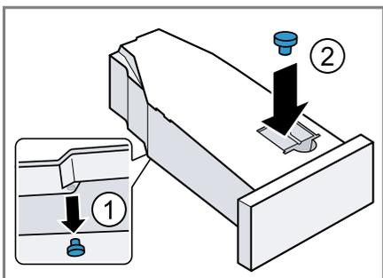
6. Mettez en place le réservoir d'eau de condensation.
