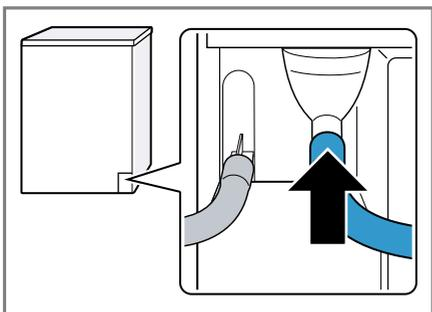
4. Vider le réservoir d'eau de condensation.
