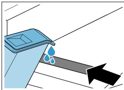
Notez le repère pour remplir le réservoir d'eau à côté de l'ouverture avant.
