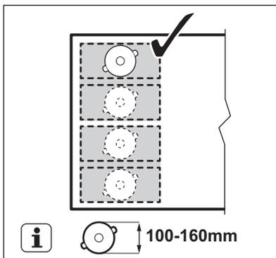
Placez l'ustensile avec un fond de plus de 160 mm de diamètre au centre entre deux sections.
