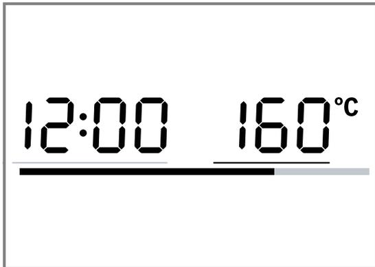
Après la mise en route, la ligne rouge dans la zone inférieure de l'écran indique la progression de chauffe de la température du compartiment de cuisson. La ligne se remplit de rouge en fonction de la progression de chauffe. L'appareil est chauffé lorsque la ligne est remplie de rouge en continu. Pour le gril, la ligne de chauffe est immédiatement remplie de rouge.
