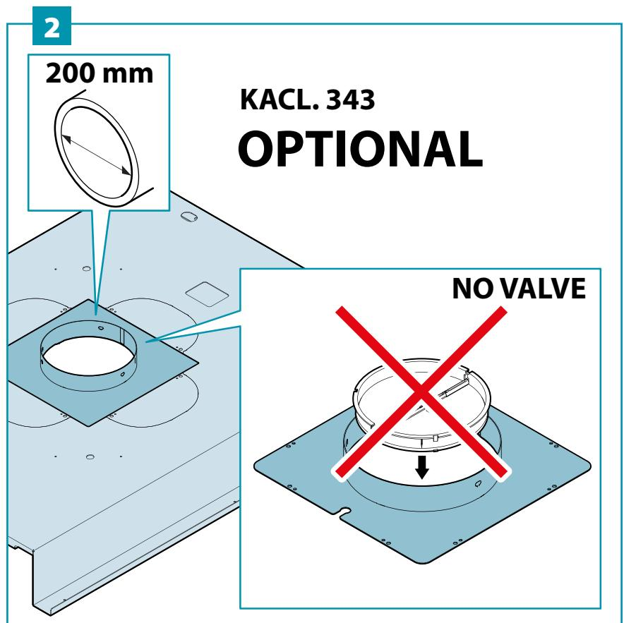
IT - Fissaggio tubo di aspirazione (3).
