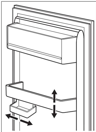
Ce modèle est équipé d'un compartiment de rangement variable qui peut être déplacé latéralement.
