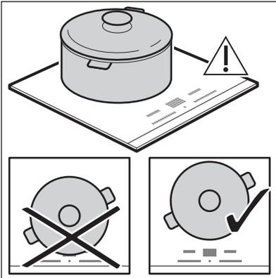
Sæt kogegrejet i midten af den valgte kogezone. Induktionskogezoneer tilpasser sig automatisk til størrelsen af kogegrejets bund.
