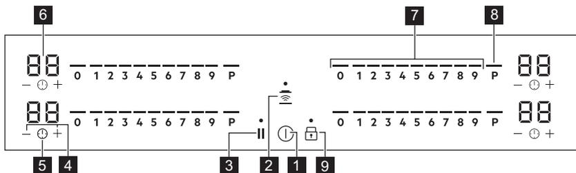
Käyttöpaneeli ja alueiden asennot tulevat näkyviin, kun laite kytketään toimintaan painikkeella ①
