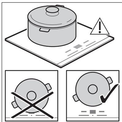
Postavte varnou nádobu na střed zvolené zóny. Indukční varné zóny se automaticky přizpůsobují velikosti dna nádoby.
