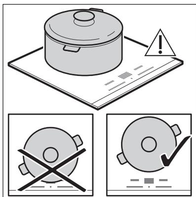
A főzőedényt a kiválasztott főzőzóna közepére helyezze. Az indukciós főzőzónák automatikusan alkalmazkodnak a főzőedény aljának méretéhez.
