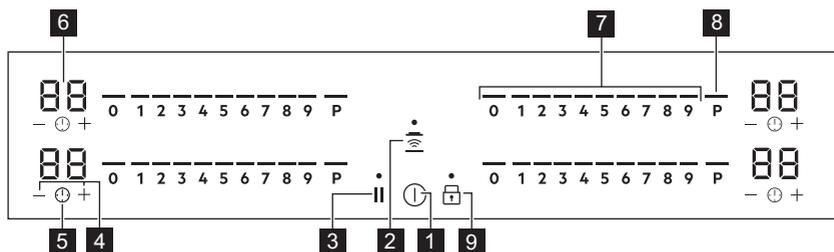
Pro zobrazení ovládacího panelu a poloh varných zón zapněte spotřebič pomocí ①.
