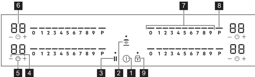
Per vedere il pannello dei comandi e le posizioni delle zone attivare l'apparecchiatura con ①. Utilizzare i tasti sensore per mettere in funzione l'apparecchiatura. I display, gli indicatori ed i segnali acustici mostrano quali funzioni sono attive.
