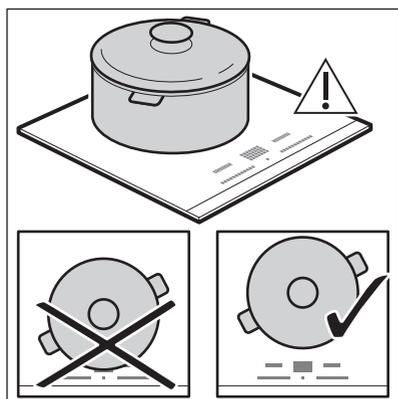
Coloque el utensilio de cocina en el centro de la zona seleccionada. Las zonas de cocción por inducción se adaptan automáticamente al tamaño de la base de los utensilios de cocina.
