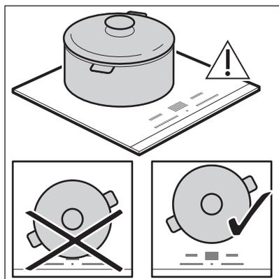
Posizionare le pentole al centro della zona selezionata. Le zone di cottura a induzione si adattano automaticamente alle dimensioni del fondo della pentola.
