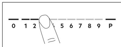
1. Premere il livello di calore desiderato sulla barra dei comandi. È inoltre possibile spostare il dito sulla barra dei comandi per impostare o modificare il livello di calore per una zona di cottura.
