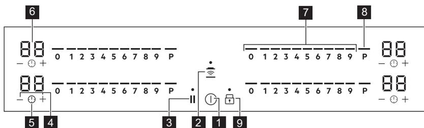
Aby sa zobrazil ovládaci panel a polohy zón, zapnite spotrebič pomocou ①
