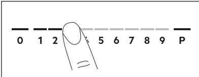
1. Tryck på önskad värmeinställning på kontrollpanelen. Du kan också flytta fingret längs kontrollpanelen för att ställa in eller ändra värmeinställningen för en tillagningszon.
