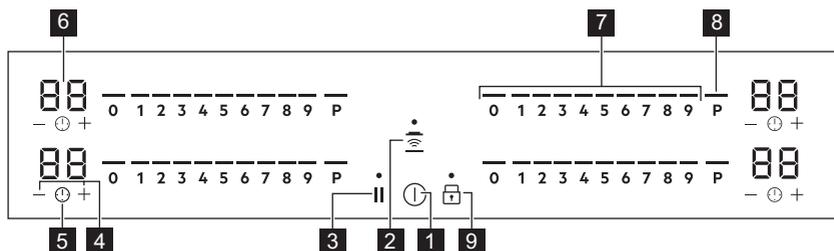
Aby wyświetlić panel sterowania i pola grzejne, należy włączyć urządzenie za pomocą ①. Urządzenie obsługuje się, dotykając pól czujników. Wyświetlacz, wskaźniki i sygnały dźwiękowe informują użytkownika o włączonych funkcjach.
