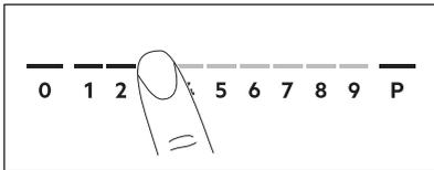
1. Tryk på det ønskede varmetrin på betjeningspanelet. Du kan også flytte fingeren langs kontrollinjen for at indstille eller ændre varmetrinnet for en kogezone.
