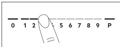
1. Натиснете желаната степен на нагриване на лентата за управление. Можете също да движите пръста си по лентата за управление, за да зададете или промените настройката на нагриване за зона за готвене.
