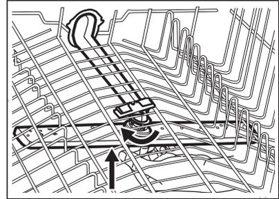
3. Reinigen Sie den Sprüharm unter fließendem Wasser. Entfernen Sie Verunreinigungen aus den Öffnungen des Sprüharms mit einem spitzen Gegenstand, z. B. einem Zahnstocher.
