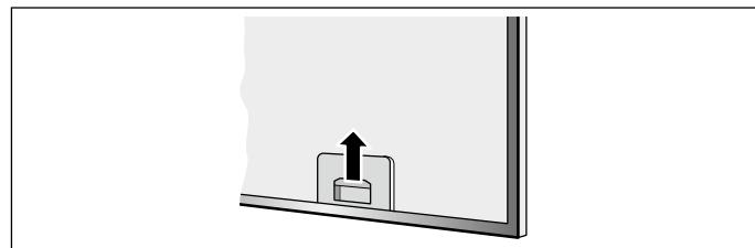
1. Verriegelung der Metallfettfilter öffnen und die Filter aus der Halterung entnehmen.
