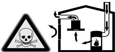
Vuurbronnen die de lucht in de ruimte verbruiken (bijv. apparaten die op gas, olie, hout of kolen worden gestookt, geisers, warmwatertoestellen) trekken de verbrandingslucht uit de opstellingsruimte en voeren de gassen via een afvoer (bijv. schoorsteen) af naar buiten.
