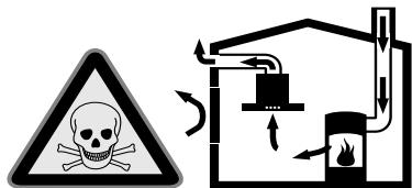
Raumluftabhängige Feuerstätten (z.B. gas-, ölf-, holz- oder kohlebetriebene Heizgeräte, Durchlauferhitzer, Warmwasserbereiter) beziehen Verbrennungsluft aus dem Aufstellraum und führen die Abgase durch eine Abgasanlage (z.B. Kamin) ins Freie. In Verbindung mit einer eingeschalteten Dunstabzugshaube wird der Küche und den benachbarten Räumen Raumluft entzogen - ohne ausreichende Zuluft entsteht ein Unterdruck. Giftige Gase aus dem Kamin oder Abzugsschacht werden in die Wohnräume zurückgesaugt.
