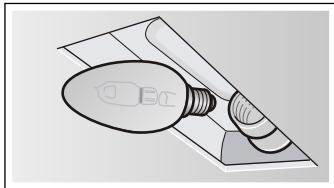
3. Remettez le couvercle de l'ampoule en place.
